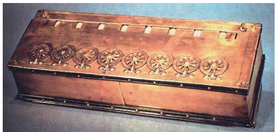
Eine «Pascaline», eine frühe Rechenmaschine von Blaise Pascal entwickelt im Jahr 1642.
